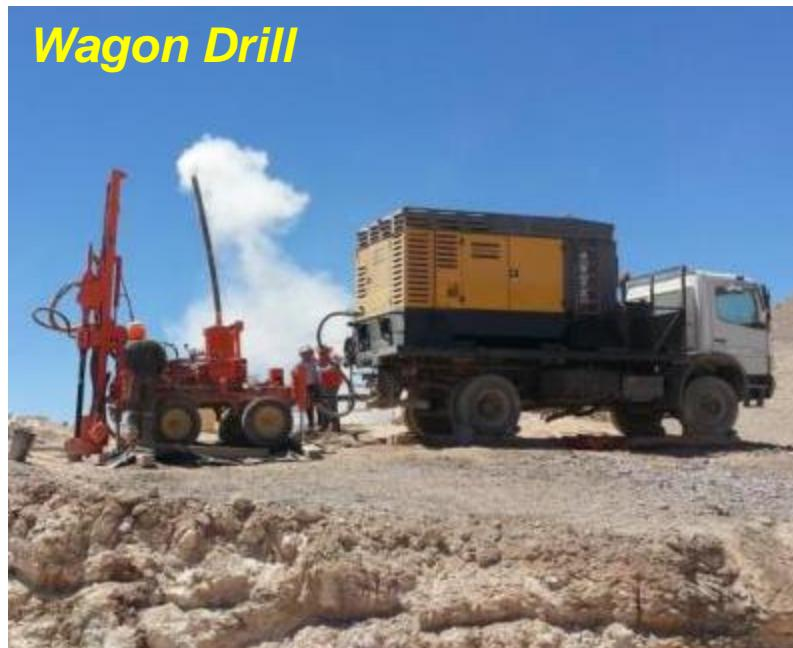
**Perforadora DDH:** DG-1000 (Ingetrol), de tipo diesel-hidráulico, montado sobre tráiler con ruedas con motor turbo diesel de 236 HP. Para perforaciones HQ hasta 500m, NQ hasta 800 m y BQ 1.000
